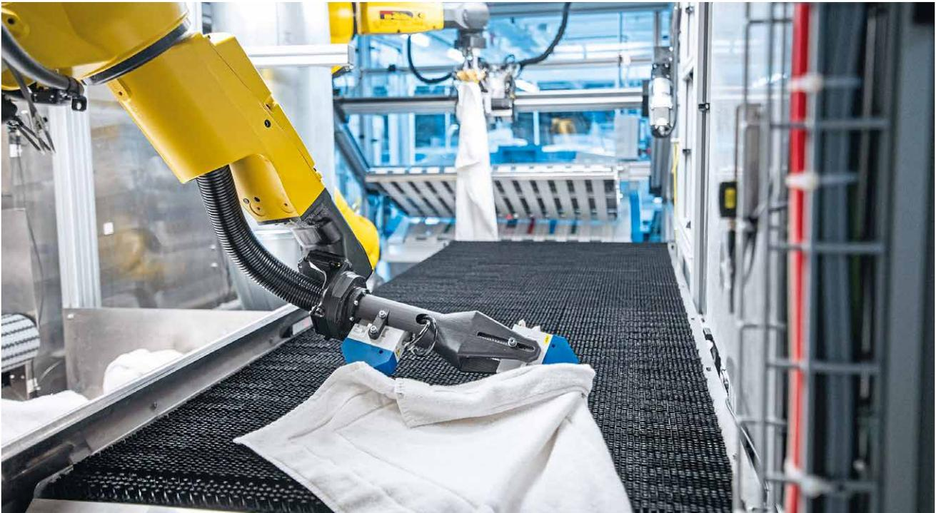
Mit Software und Kamertechnik begegnen Roboter der Verformbarkeit von Textilien – nun im Praxiseinsatz bei der Firma Greif Textile Mietsysteme in Wolfratshausen.
